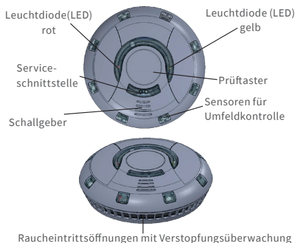
Abb.1: Rauchwarnmelder EASY PROTECT Radio (grau schattierte Darstellung)
