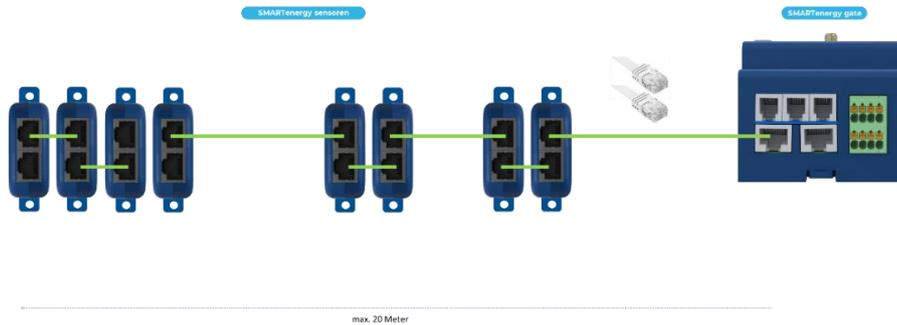
Der Anschluss der SMARTenergy Sensoren erfolgt über Standard RJ45 Netzwerkkabel AWG27. Es können bis zu 8 SMARTenergy Sensoren an der SEB Anschlussdose angeschlossen werden. Die max. Distanz zwischen Anschluss SMARTenergy gate und letzter SMARTenergy sensor ist 20m.
