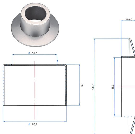
Bereits vorhandene, verchromte Rosetten von Supercom 281 und Wasserzählern mit Supercom 581 / 587 können weiter verwendet werden. Aufgrund des hohen Chromanteils ist jedoch mit einer verminderten Funkreichweite zu rechnen. Bestehende originale Rosetten von Minol und Techem können nicht verwendet werden.
